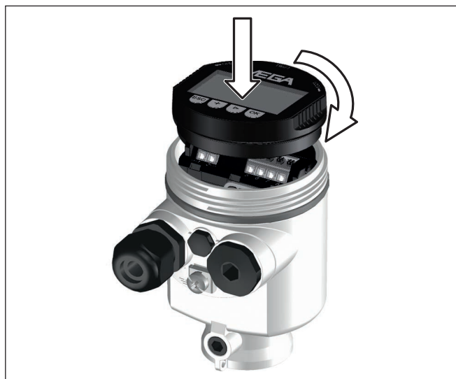
Рис. 35: Установка модуля индикации и настройки в отсеке электроники однокамерного корпуса
