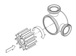
Перед установкой крыльчатки (02) смажьте ее специальной пищевой смазкой. Устанавливайте крыльчатку (02) в корпус (01) в соответствии с направлением вращения насоса
