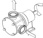
Быстро включите и выключите насос, чтобы двигатель начал вращение, и отследите по крыльчатке электродвигателя направление вращения.
