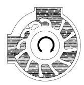
Специальная форма насосной части образует объемы, в которых создается разряжение и куда всасывается продукт. При этом данный объем между корпусом и лопастями увеличивается прогрессивно.
