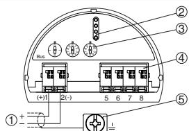
Отсек электроники и подключения (однокамерный корпус)
