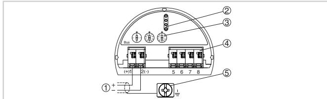
Отсек электроники и подключения (однокамерный корпус)
